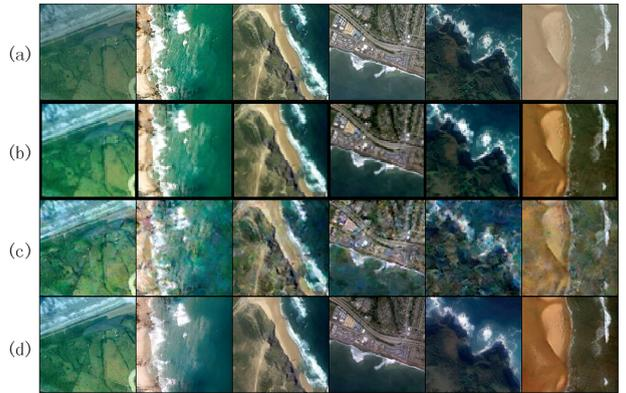
(a) 原始高分辨率图像 (HR); (b) 具有相同空间分辨率的低分辨率图像 (LR); (c) 残差低分辨率图像; (d) 模型生成的超分辨率图像 (SR).
